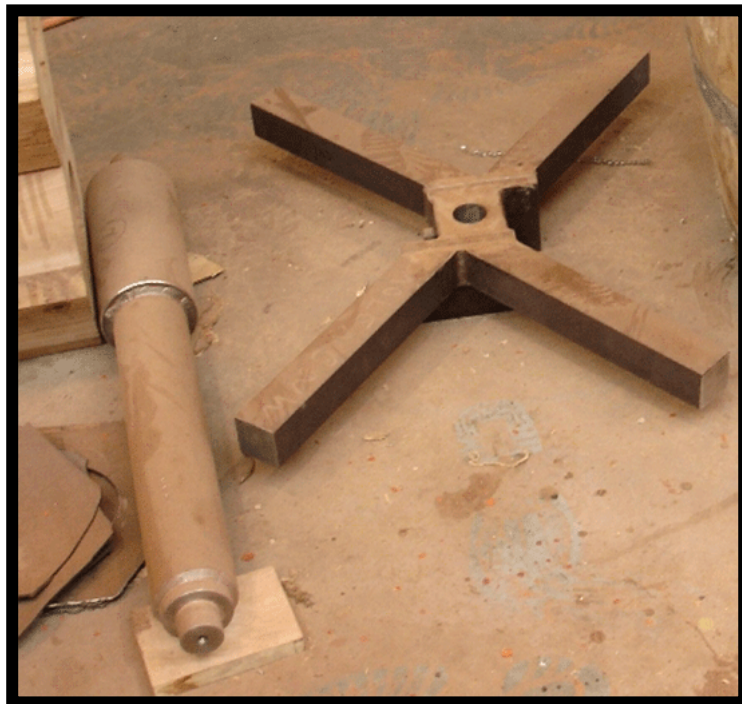
Anille à quatre bras, encavée dans la meule Petit fer où repose la meule
